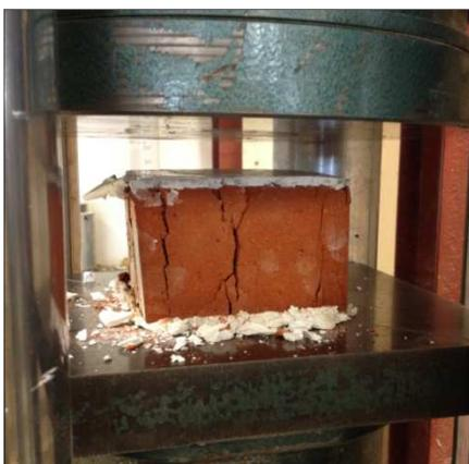
(d) Typical clay brick compression test setup
